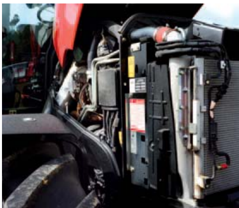
^ Onderhoud Voor het dagelijkse onderhoud is de motor redelijk goed toegankelijk. Oliepeilen is bij gesloten motorkap geen probleem. Het reinigen van het koelpakket gaat ook gemakkelijk, als je de clipjes los krijgt.
