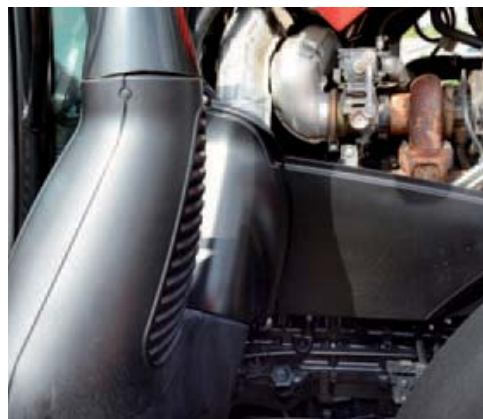
^ AdBlue Het is vol onder de motorkap. De motor, van zusterbedrijf FPT, voldoet aan de Stage 4 milieueisen. Daarvoor is hij voorzien van een SCR-systeem. AdBlue tanken moet.
