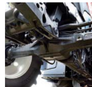
^ Geveerde vooras De vooras van de trekker is optioneel geveerd. De veerweg bedraagt 10,5 cm, 6 cm omhoog en 4,5 cm naar beneden.
