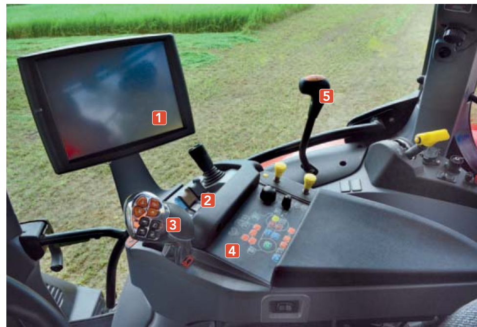
^ In de cabine In de armleuning zijn alle belangrijke bedieningselementen ondergebracht. Met het touchscreen bedien je onder meer het kopakkermanagement [1]. Er zijn flippers [2] voor de hydraulische ventielen en met de Multicontroller [3] heb je de bediening van de motor, de transmissie en een ventiel binnen handbereik. Met tiptoetsen [4] schakel je de bijvoorbeeld de voorasvering in en uit. Met een hendel [5] schakel je tussen de veld- en transportgroep.
