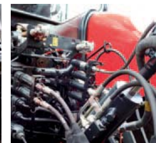
^ Hydraulische ventielen De hydraulische ventielen zijn nu links en rechts van de topstang te vinden.
