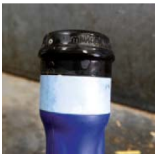
De luchtinlaat op de tepelbeker is verplaatst naar de bovenkant.
