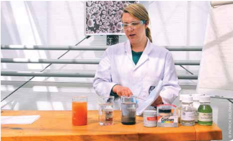
Laborante Vicky demonstreerde het belang van goede grondstoffen en de juiste hulpstoffen om die grondstoffen te helpen oplossen en in oplossing te houden. In de linkse beker zit goed oplosbaar koperoxide, in de beker rechts ervan is het naar de bodem gezonken zonder op te lossen.
