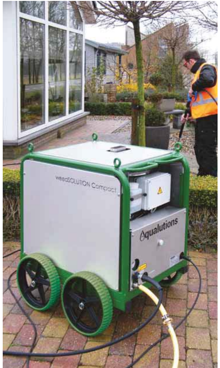
De WS Compact voor de hovenier heeft een buitenkraan en een stopcontact nodig om effectief onkruid te bestrijden.
