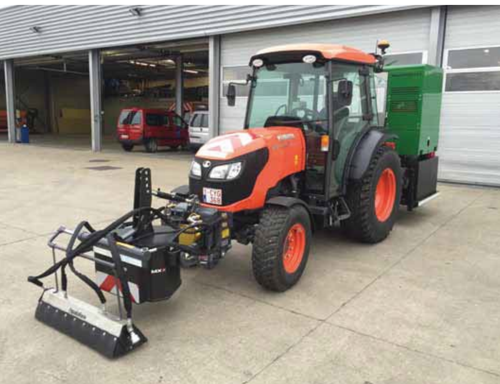
Met een spuitbalk wordt onkruidverwijdering gemakkelijker, in dit geval met een brede balk (100-230 cm) en de WS II.
