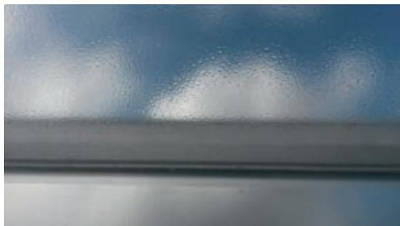
**Abbildung 1.10** Kondenswasserbildung auf der Innenseite der Folie, hydrophil (A) und auf der Außenseite der Folie hydrophob (B).
