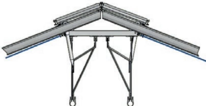
**Abbildung 1.3** Position des durchlaufende Firstlüftung in 2SaveEnergy-Gewächshaus. Die Folie ist in blau unter der Strebe zu sehen.
