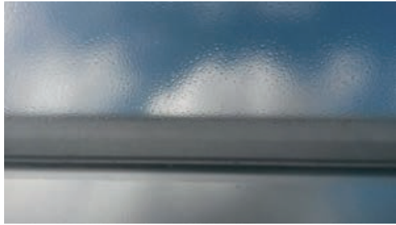
Figuur 1.10 Condensvorming aan de binnenzijde van de film, hydrofiel (A) en condensvorming aan de buitenzijde van de film, hydrofoob (B).
