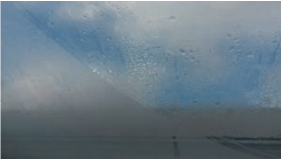
Figuur 1.10 Condensvorming aan de binnenzijde van de film, hydrofiel (A) en condensvorming aan de buitenzijde van de film, hydrofoob (B).
