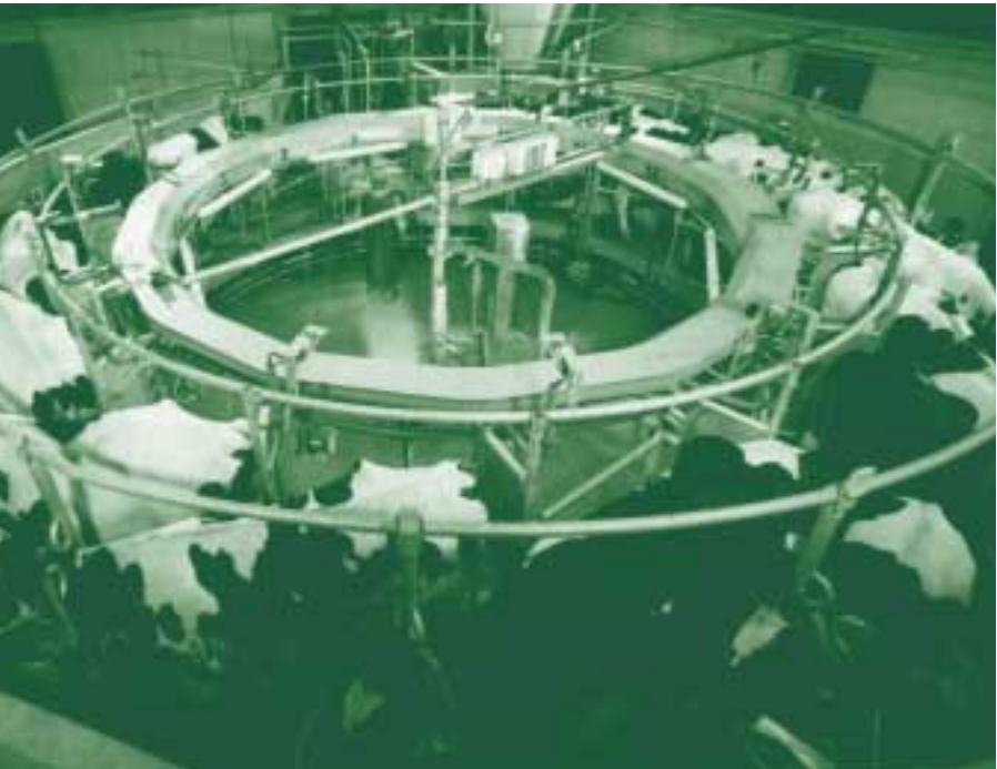
Een draaimelkstal haalt een hoge capaciteit.
