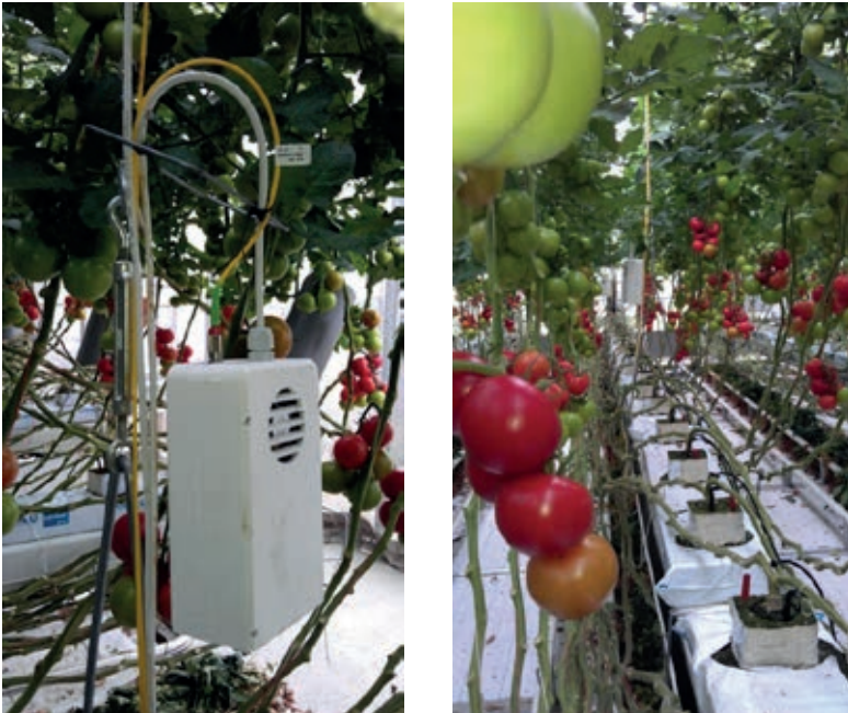
Figuur 2.13 Sensorkastjes opgehangen in de kas.
