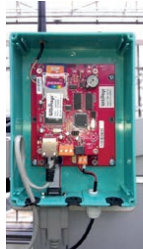
Figuur 2.2 Standaard draadloze sensor voor RV,T voor controle van het klimaat interrogator, losse print van RV,T sensor voor in de meetkastjes en een opengewerkt basisstation (Wireless Value B.V.).
