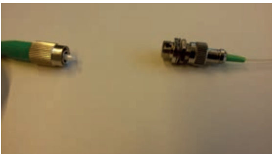
Figuur 2.3 Glasvezel connectoren en standaard glasvezelkabel.
