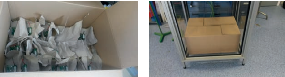
Figuur 2.8 Sensorprintjes in doos voor gelijkheidstest (links: eerste test in grote doos; rechts: tweede test in 3 dozen).
