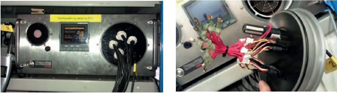
Figuur 2.10 Kalibratieopstelling met Rotronix mini-kalibrator (links) en 20 stuks elektronische sensoren gemonteerd in deksel samen met de Rotronic referentie sensor (rechts).
