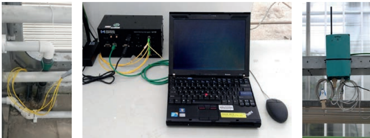
Figuur 2.15 De meet PC en interrogator in de technische ruimte van de hoofd proefkas in Bleiswijk (midden). De vier patch-cords gaan door een mantelpijp, welke uitkomt in de 2SaveEnergyKas (links) en het basisstation voor draadloze communicatie gemonteerd daarboven (rechts).
