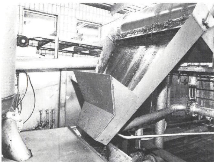
De mechanische zuivering van het afvalwater met zeef en flotatie-afscheider.
