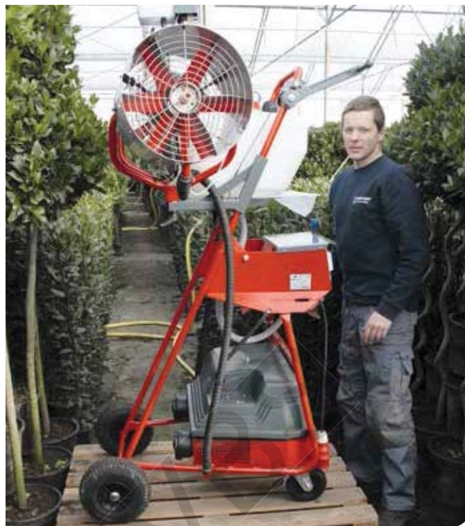
▲ Fogapparaat 'Fontan Twinstar' opgesteld op het middenpad tussen de planten
