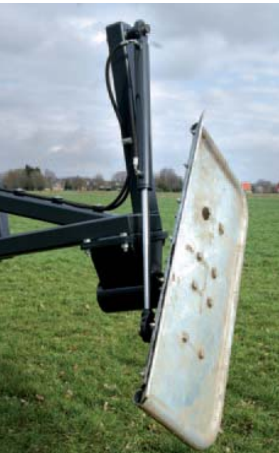
Het gegalvaniseerde schuifbord van de Armadis-kuilschuif kun je hydraulisch draaien. Zo kun goed de vorm van de kuil volgen.
