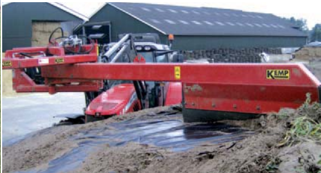
Het topmodel van Kemp lijkt wat werkingsprincipe betreft op de kuilschuif van Flingk. Verschil is dat de arm van de Kemp-kuilschuif voorlangs zwenkt. Daardoor kun je ook al schuiven als je niet volledig dwars op de kuil staat.
