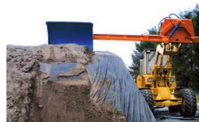
De kuilschuif van Flingk heeft een lange arm die haaks op de shovel of trekker staat. Door voor de kuil langs te rijden, schuif je het zand via de zijkant van de kuil.
