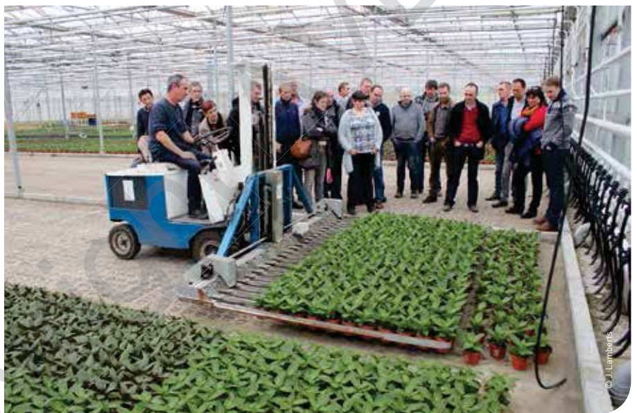
▲ Een demonstratie met de space-o-matic, een voorbeeld van arbeidsbesparing, voor het wijder zetten van Impatiens New-Guinea
