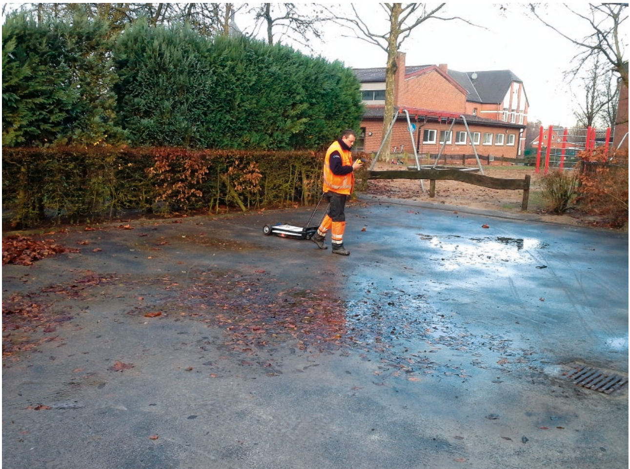
Figuur 6.8 Gebruik grondradar
