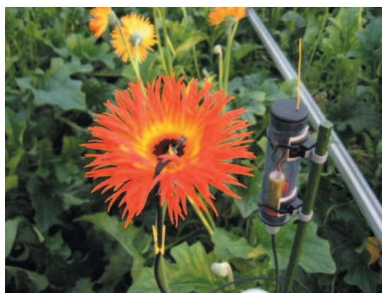
Draadloze sensor voor meting microklimaat rond bloem
