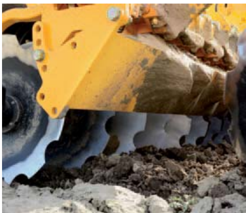
^ Het onkruidbord Achter de eerste rij schijven is een onkruidbord gemonteerd. Het breekt kluiten waardoor het ook onkruidwortels van grond onttrekt. De hoek van het bord en dus de intensiteit is in vier stappen verstelbaar.
