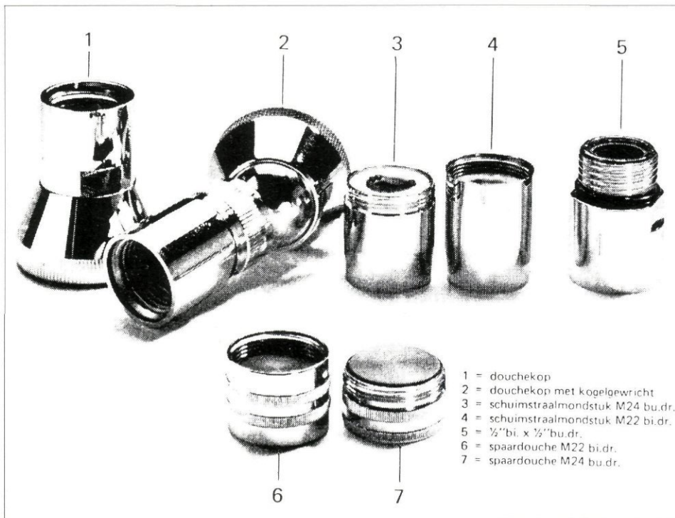
Afb. 1 - Volumestroombegrenzers systeem Flowfix voor volumestromen van respectievelijk 0,05, 0,10 en 0,15 l/s.
