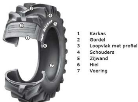
Figuur 5. De opbouw van een tractor band (Vaco, 2011).
