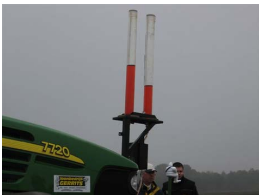
Figuur 4. De linker buis toont de overgebleven brandstof bij 0.8 bar. De rechter buis toont 19% meer brandstofverbruik bij 1.8 bar (IRS, 2008).
