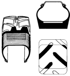
Figuur 7. Opbouw van de radiaalband en bijhorende vervorming (Vaco, 2011).
