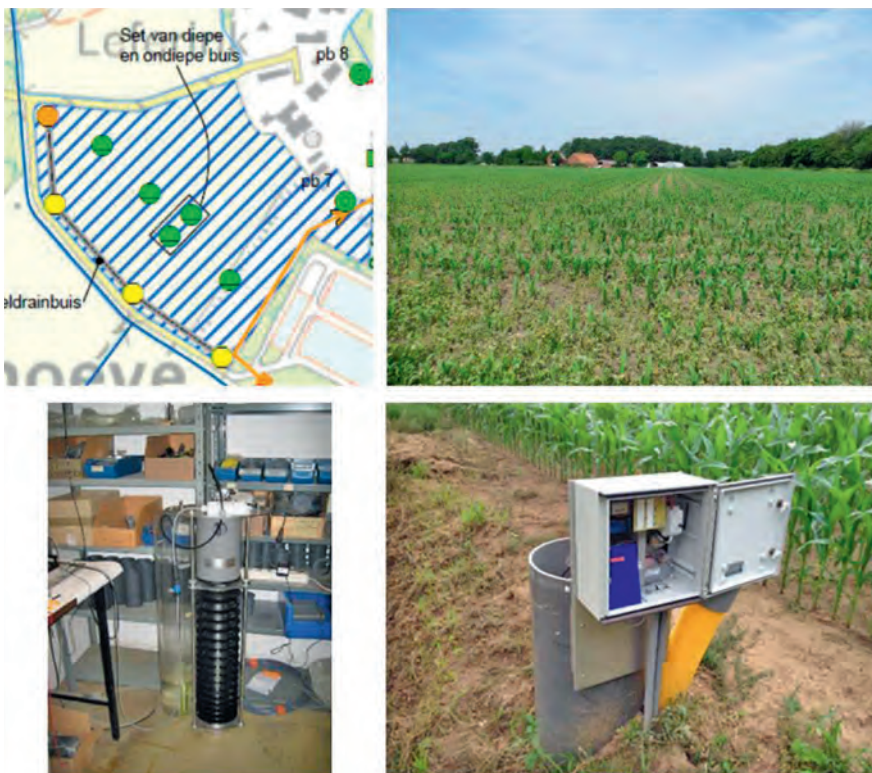
Afbeelding 2: KAD-perceel in Haaksbergen (5,5 ha). Linksonder: opzet van het KAD en monitoringsysteem; ligging peilbuizen in groen, verzamelput in oranje, vlotterputten in geel. Rechtsboven: foto van het snijmaais-perceel in juni 2013. Linksonder: mechanische installatie voor controle drainagebasis die geïnstalleerd wordt in de verzamelput. Rechtsonder: op afstand bestuurbare controle-eenheid met daarachter de verzamelput.
