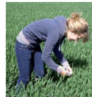
▲ Chlorofylmeting Meting met een Yara N-tester in een perceel wintertarwe.
