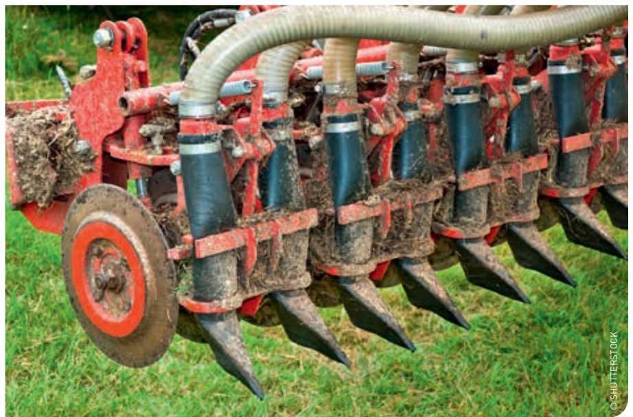
Een sleepvoetbemester werkt min of meer volgens hetzelfde principe als een sleufkouter. De sleepvoeten lichten het gras op en leggen de mest af tussen het gras.
