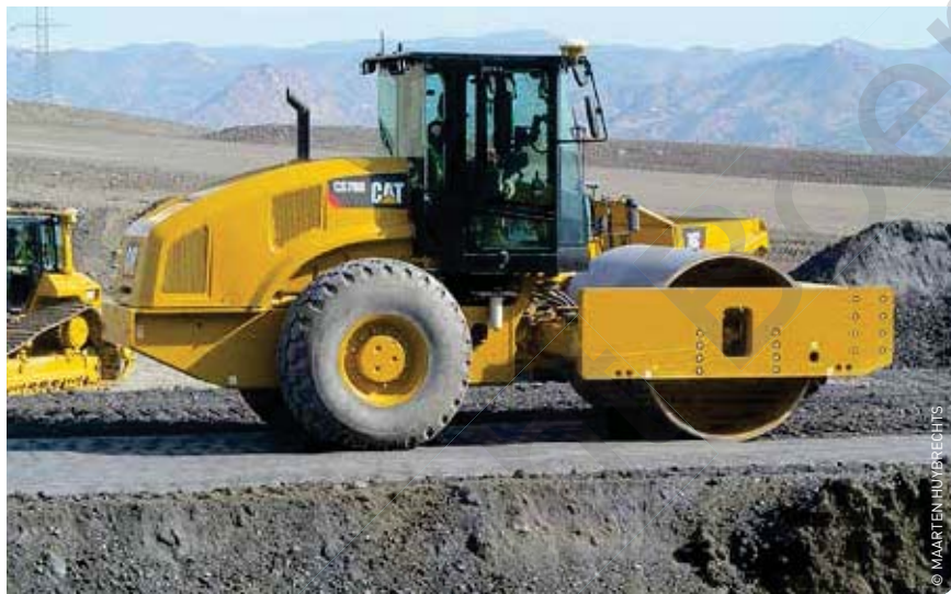
Het compactorvoertuig wordt hydraulisch aangedreven. Het vermogen hiervoor wordt continu gemeten. Omdat de zachte ondergrond meer vermogen vraagt dan harde ondergrond kan een kaart van de ondergrond opgemaakt worden.
