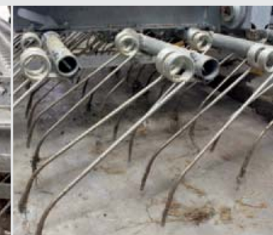
De rijen met flexibele tanden in, hier een slepende stand.
