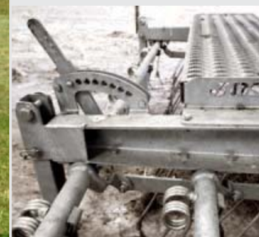
Met een hendel stel je de tanden steiler of juist slepender. Hoe steiler je de tanden afstelt, hoe agressiever de machine werkt.
