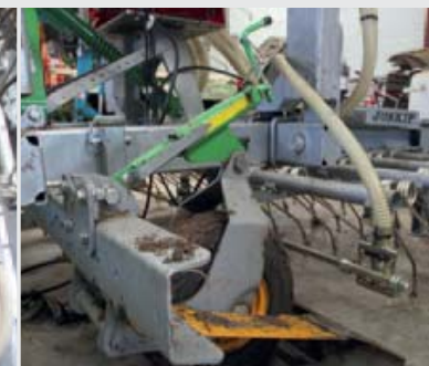
Met een draaihendel stel je de hoogte van de sleepscraper in.
