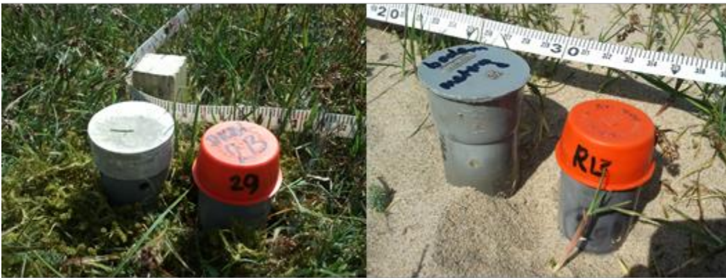
Figuur 5-4 PVC buisjes om mineralisatie te meten in verzuurd stroomdalgrasland (Koekoekswaard). Links: controle proefvlak, rechts: proefvlak bedekt met rivierzand.
