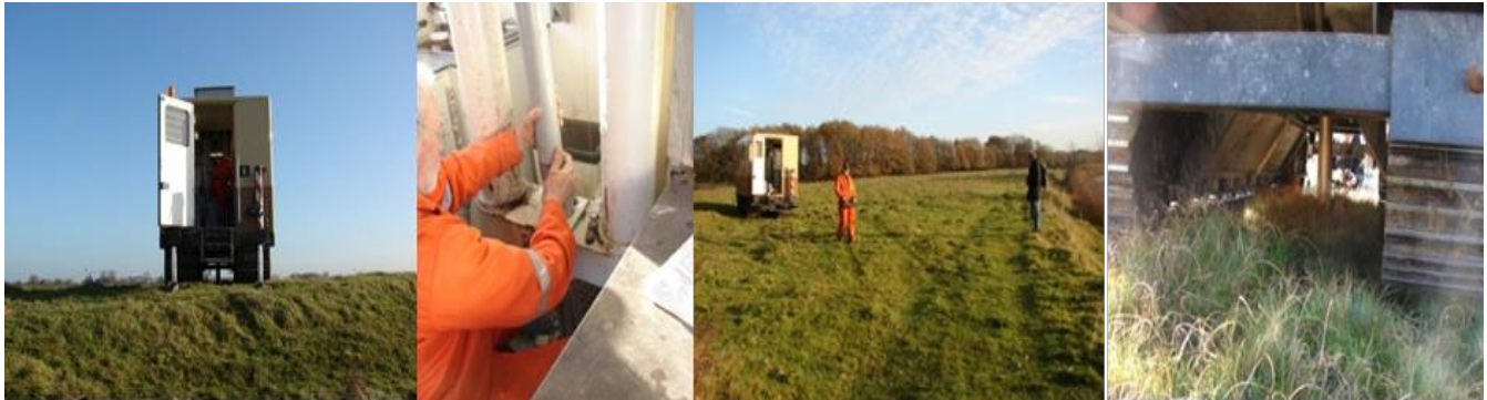
Figuur 7-3 Het nemen van ongestoorde bodemprofielen (Begemann methode).
