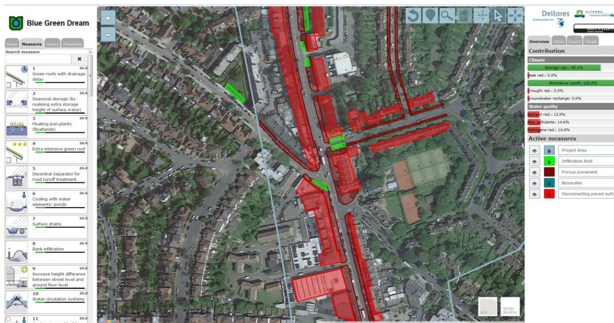
Afbeelding 4. Beeld van de Adaptation Support Tool. Links de lijst van 62 blauwe, groene en grijze maatregelen waaruit de gebruikers kiezen; midden het projectgebied met een aantal ingeplande maatregelen. Rechts het 'dashboard' met daarop de totale prestaties van alle maatregelen in relatie tot de wateropgaven of (niet getoond) de prestaties en kostenschatting per maatregel.
