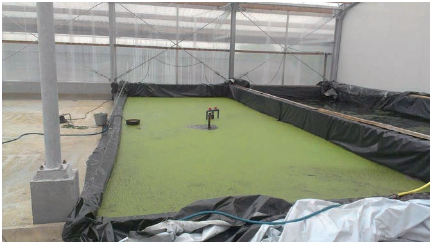
Figuur 27: De opzet van test 4 met dompelpomp voor menging en zuurstof. Rechts op de foto is de eerdere testvijver met afgestorven kroos nog net zichtbaar.
