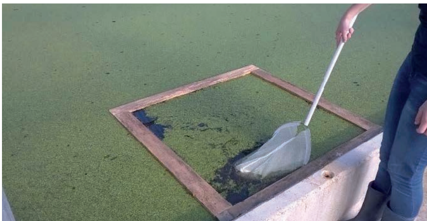
Figuur 18: Kroosdichtheidsmeting met een frame van 1 [m 2 ] en een schepnet.
