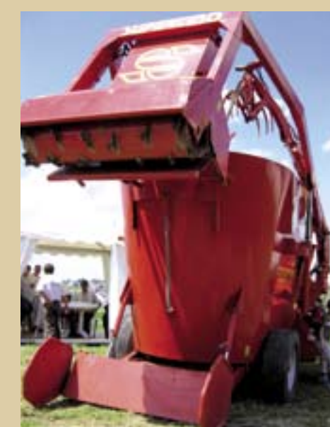
De Supertino zelfladende verticale voermengwagen is voorzien van een freese.
