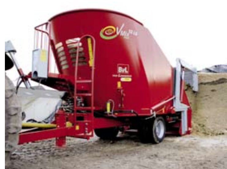
De zelfladende BvL voermengwagen is wendbaar door een korte wielbasis en kan achter lossen.
