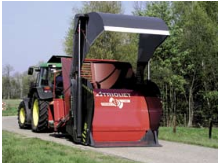
De fabrikant van Trioliet biedt haar voermengwagens met verticale vijzel aan met een bewegend mes of een stansmes.
