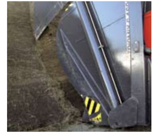
Als de kuil goed vast is gereden, geeft het stansmes van Trioliet een strak snijresultaat.
