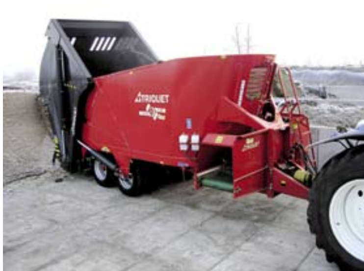
Trioliet en BvL bieden ook grote zelfladende wagens met twee vijzels aan.
