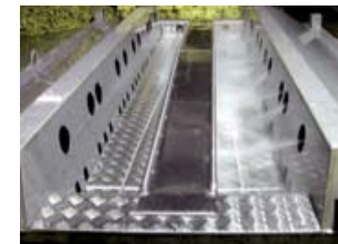
MT Klovvask ontwikkelde een klauwbehandelsysteem dat in de terugloopgang van de melkstal geplaatst wordt.
