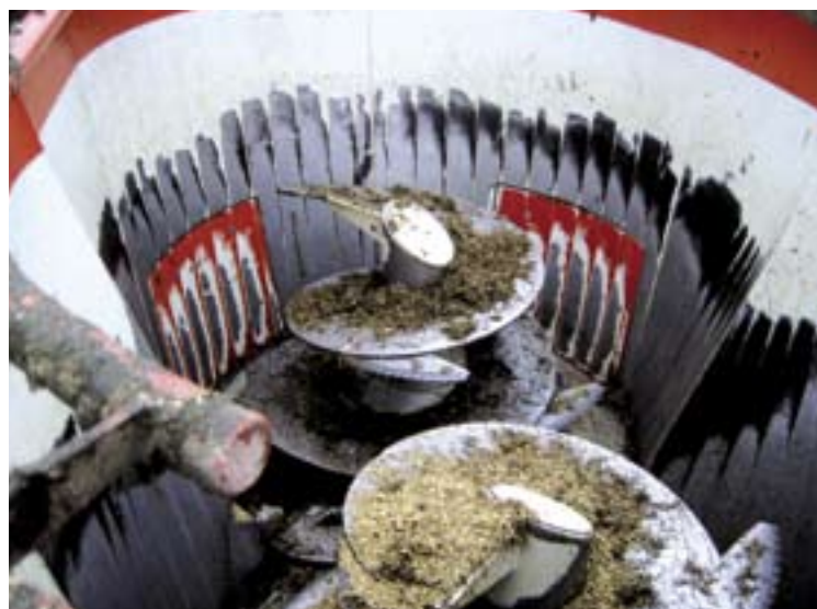
Aan de slijtage van de verf is de verkanting van de kuip goed te zien.
