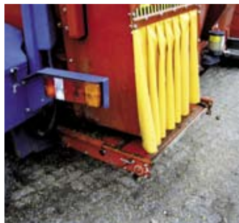
De losband is verstelbaar zodat deze dichterbij het voerhek kan komen.
