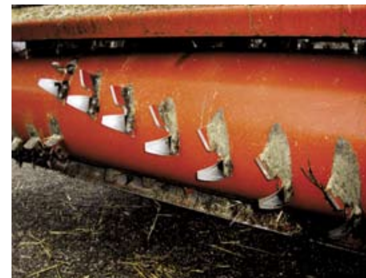
De messen van de Siloking zijn gebogen met daarachter een metalen plaat om het voer af te voeren.
