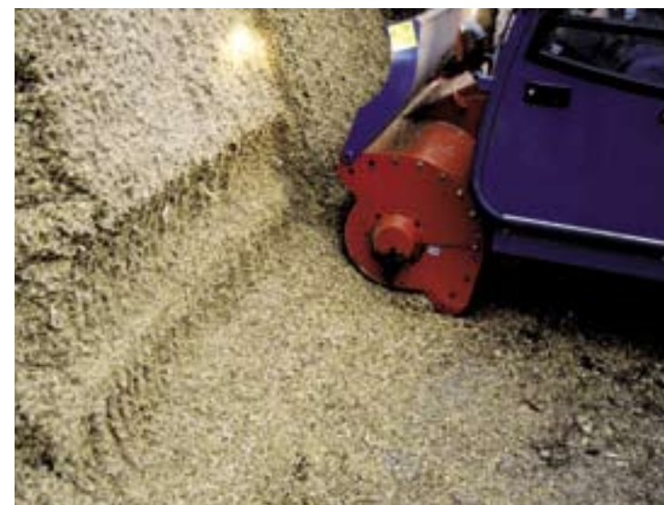
De frees haalt het voer uit de kuip en de schraper zorgt ervoor dat de kuiplaat schoon achterblijft.
