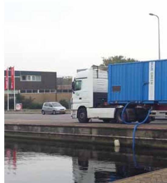
De mobiele biomassa-installatie verwarmt water op locatie.
