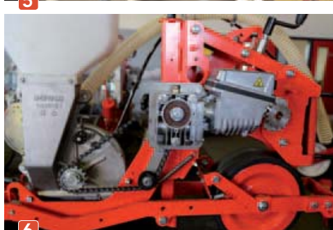
[4] De 'versnellingsbak' biedt maximaal 36 versnellingen bij een mechanische aandrijving.
