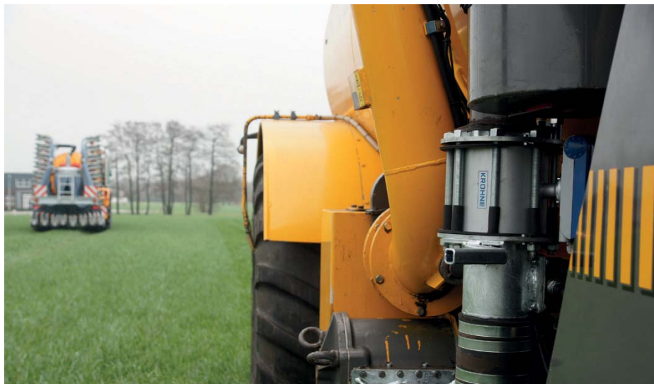
Op de Vervaet-zelfrijder kan de NIR-sensor gemakkelijk in de pijp net achter de pomp worden gebouwd.
