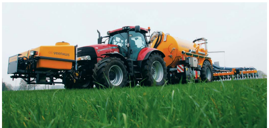
De fronttank van 1500 liter met doseersysteem wordt gekoppeld aan het Isobus-systeem.
