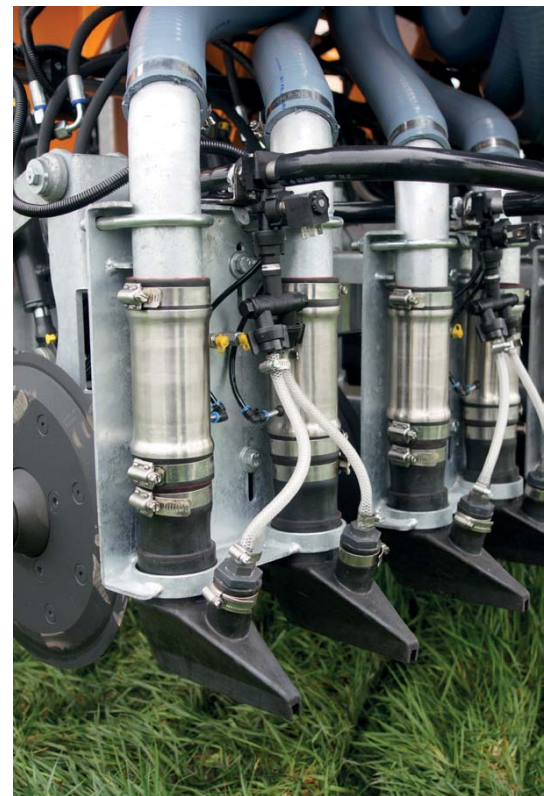
Vloeibare kunstmest wordt in de voetjes bij de drijfmest gevoegd.
