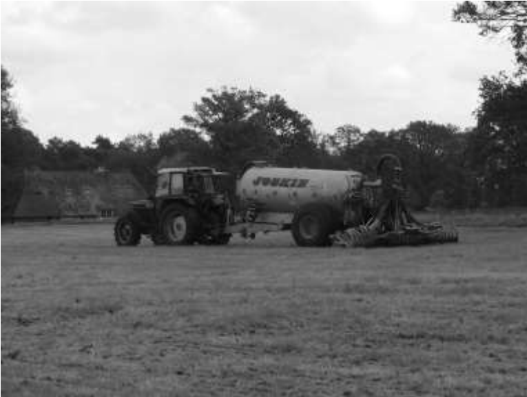
Afb. 4: Bij de bemesting van productiegraslanden komt veel ammoniak (NH 3 ) vrij die tot stikstofdepositie en verzuring leidt. Door de mest te injecteren wordt dit beperkt (foto: Natuurmonumenten / Herman Veerbeek).
