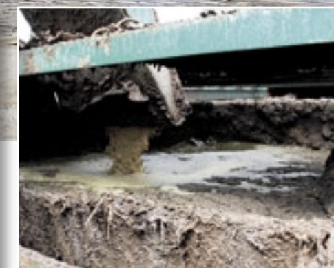
Op het melkveebedrijf Hinton Holsteins draait een vijzel een keer per dag de mest in de zandwasser.
