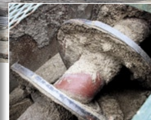
Een vijzel scheidt mest en zand van elkaar. Om dat proces te versnellen wordt water toegevoegd.
