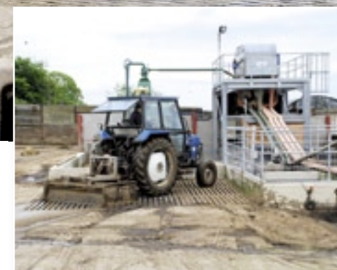
Tweemaal daags wordt de mest met een trekker en een mestschuif uit de stal in een 5 kuubs put gereden.
