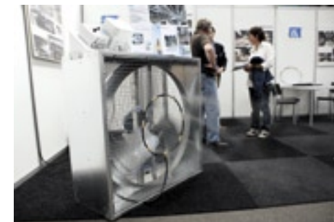
Aerotech ventilator met waterverneveling.
