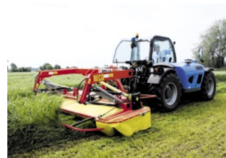
Landini Powerlift met Fella SM310FZ-KC frontmaaier.
