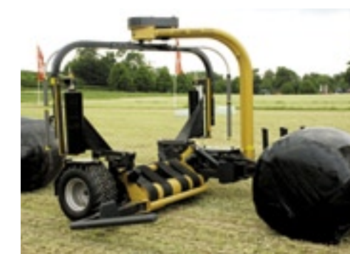
Tanco's nieuwe wikkelaar legt een gewikkelde baal weg en pakt tegelijkertijd een nieuwe op.
