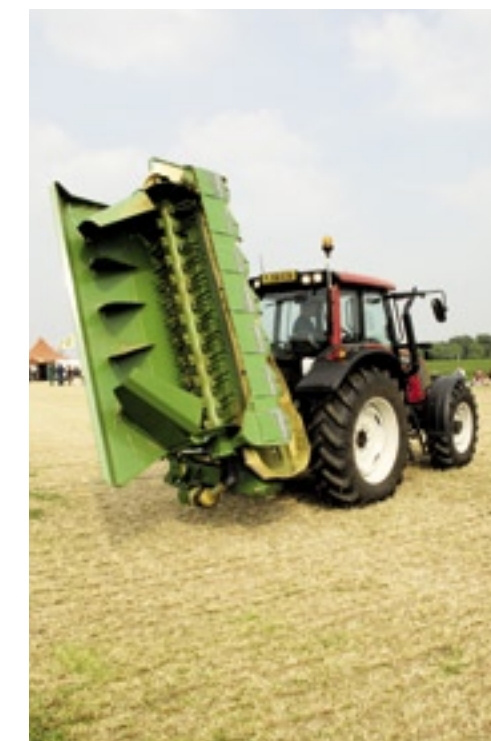
Krone toonde de 320 CVQ. Om stabiel achter de trekker te hangen, klapt hij door het midden.
