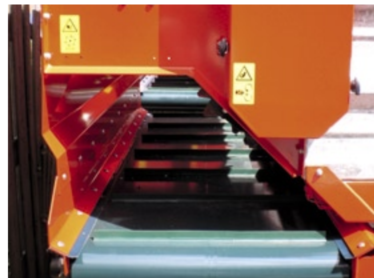
Op de linkerfoto is de naadloze afwerking van de dwarsafvoerband te zien. De eigenaar van de machine op de rechterfoto heeft een extra schuine plaat gemonteerd voor een betere afvoer van het voer.
