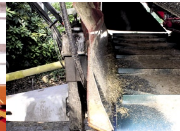
Optioneel kan de voerwagen worden voorzien van een rubberafscherming boven de dwarsafvoerband. De weegmonitor kan scharnieren en is zo afleesbaar tijdens laden en lossen.
