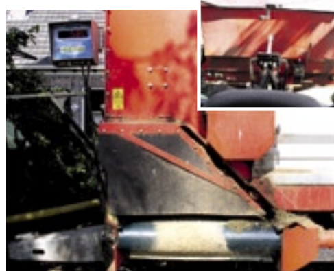
De bodemketting en de dwarsafvoerband worden hydraulisch bediend. Vanuit de trekker kun je bij de hydrauliekhendels en de regelventielen.
