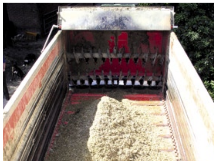
Het schroefvormige systeem van de loswalsen werkt het voer naar het midden toe. Dit voorkomt het vastlopen van de walsen. Het afschermdoek staat in de laadpositie omhooggeklapt.
