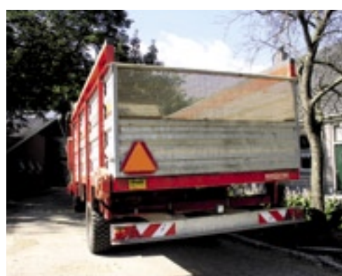
De bovenscharnierende achterklep is gemakkelijk te openen bij calamiteiten. De wagen is uitgevoerd met een zeer degelijke bumper.
