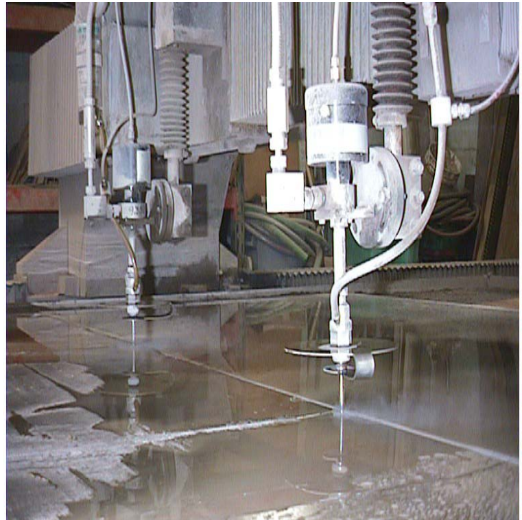
Figuur 4 Een CNC gestuurde erosieve waterstraler.
