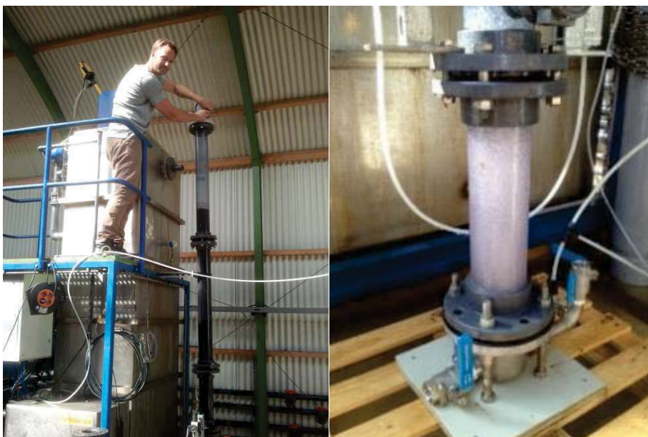
Afbeelding 1: Testopstelling (links) met gasdosering via beluchtingsschotel (rechts, in schoon water)
