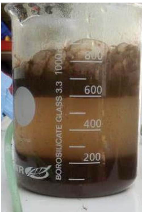
Afbeelding 2: Bezinking als gevolg van kortdurende beluchting aan het begin van de flotatiecyclus (test 2)
