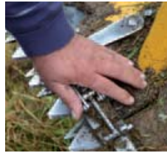
Hobelman heeft een kliksysteem om bij een maaikorf met opklapbare zijanten het mes snel te (ont)koppelen. Bij Landreus en Rumex worden de messen aan elkaar geschroefd.
