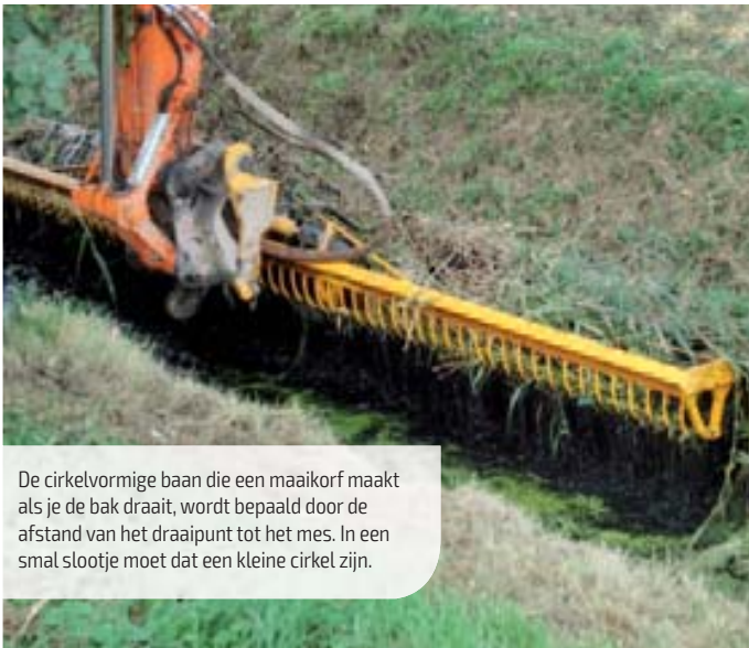
Hobelman heeft een kliksysteem om bij een maaikorf met opklapbare zijanten het mes snel te (ont)koppelen. Bij Landreus en Rumex worden de messen aan elkaar geschroefd.
