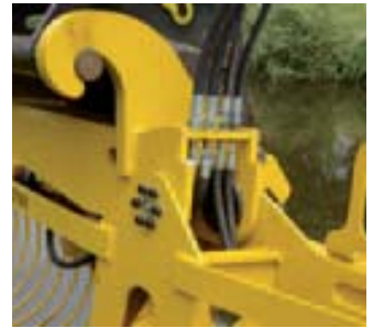
Om te kantelen werkt Rumex met twee busen in plaats van een doorgaande pen. Volgens de fabrikant is dat sterker, plus dat er in het frame ruimte blijft voor de slangen.
