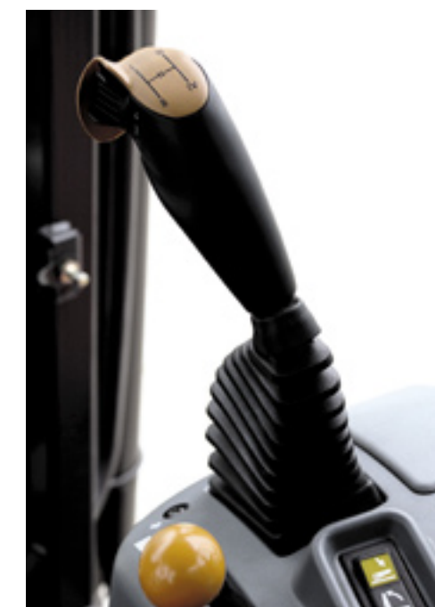
De vierbak schakelt stug. Met de rechterduim bedien je de viertraps-powershift.
