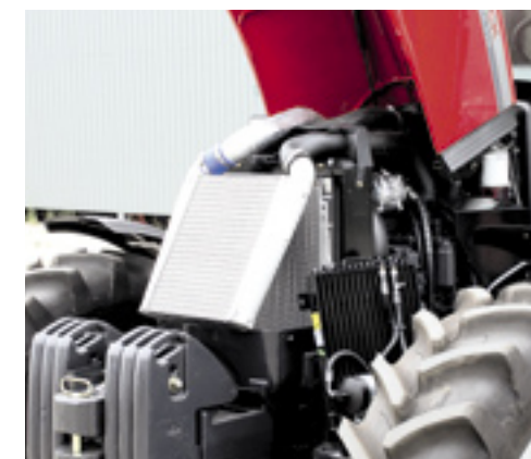
Het pakket koelers goed reinigen vraagt sleutelwerk en tijd.
