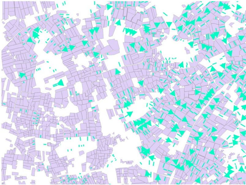
Figuur B3.2 Detail overlay drainagekaart van het waterschap (turquoise) met de buisdrainagekaart 2012 (paars).
