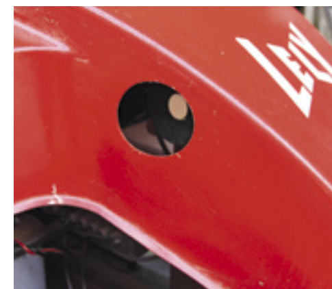
De Juno meet de afstand tot het voerhek met ultrasoonsensoren.
