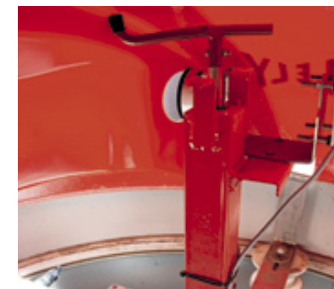
De hoogte van het neuswiel van de Juno is verstelbaar.
