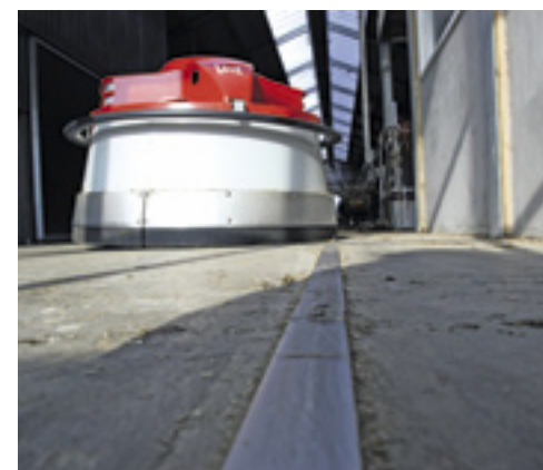
Een stalen strip geleidt de schuifrobot naar zijn oplader.
