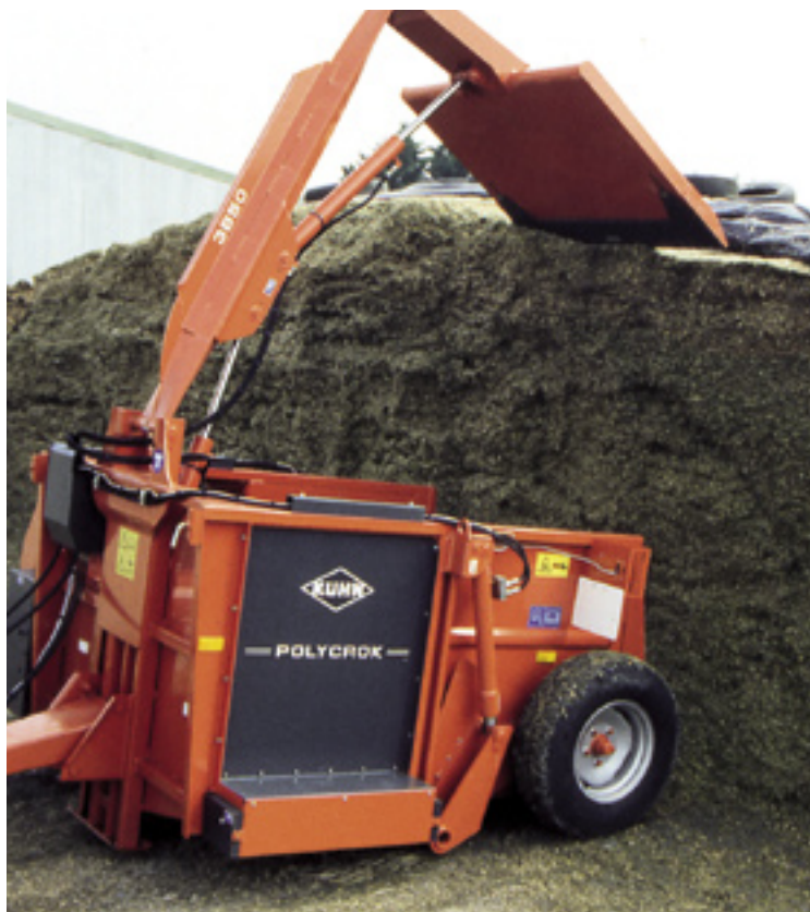
De getrokken Polycrok van Kuhn heeft standaard bowdenkabelbediening en grote transportwielen.
