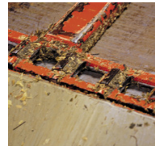
Zowel Trioliet als Holaras maken gebruik van een platte ketting.
