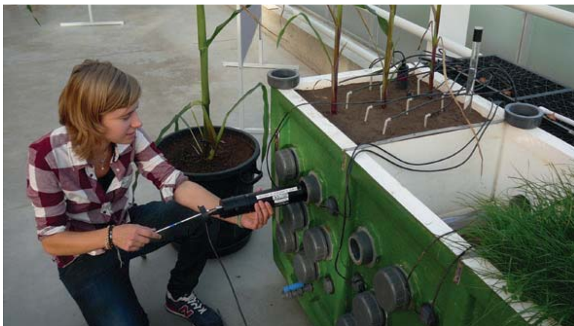
Promovendus Dina in 't Zandt bij de proefopstelling voor het meten van wortelgroei zonder de wortels te verstoren.
