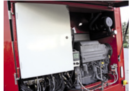
De voerrobot wordt aangedreven door een 48 kW Deutz-motor. Is de brandstoftank bijna leeg, dan krijgt de veehouder een sms.
