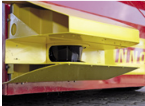
Een laserscanner houdt het terrein voor en achter de robot in de gaten. Komt een obstakel te dicht in de buurt, dan stopt de Innovado.
