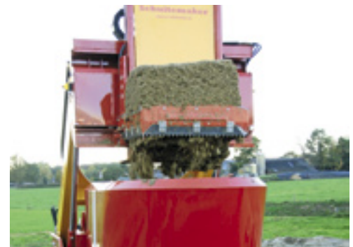
Tijdens het lossen trekken de tanden zich terug en valt het blok in de mengbak. Om maïs niet voortijdig te laten vallen, wil Schuitemaker een plaat onder de tanden monteren.
