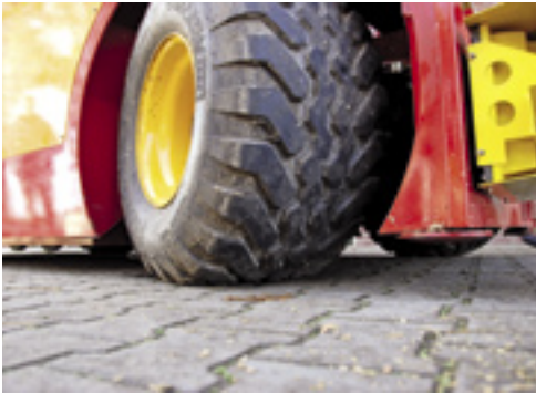
Schuitemakers voerrobot is vierwielbestuurd en vierwielaangedreven. Hydraulische steunpoten ondersteunen de machine als hij het voer op grote hoogte uitkuilt.
