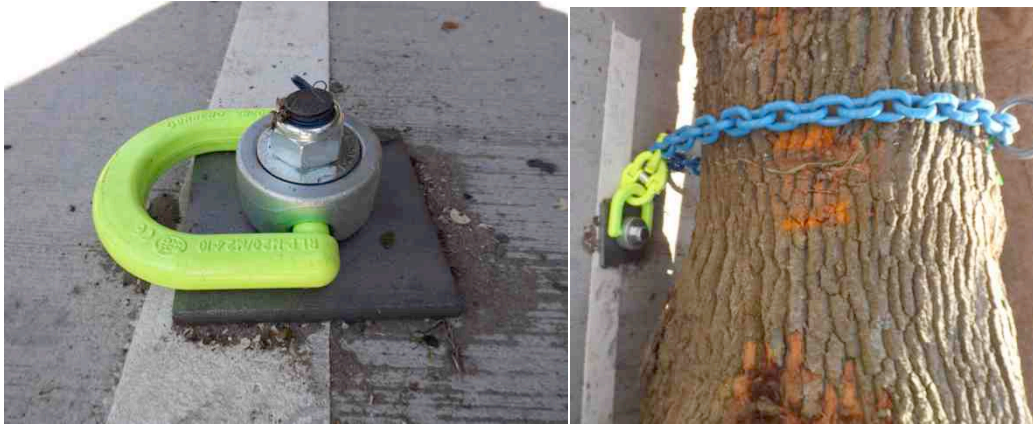
Figuur 11,12: Hijssoog en schakel met ketting gebruikt bij de bomen bij Wageningen
