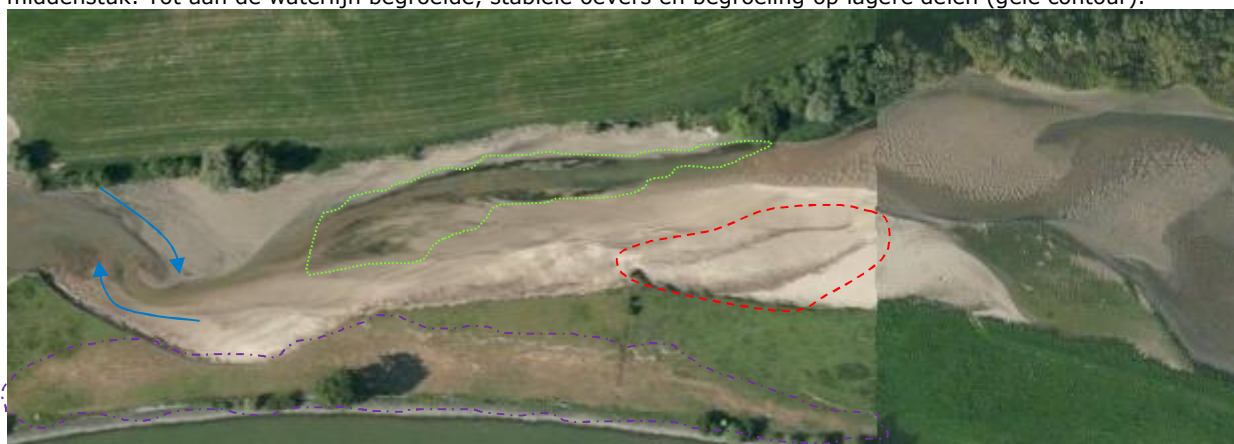
Opname 2011 van het smallere, ondiepe middendeel van de strang. Hoogwatersedimentatie (vermoedelijk uit de hoofdgeul) op de begroeide hoge landstrook links van de strang (paarse onderbroken lijn). Hoge steilranden langs een lager onbegroeid flauw zand talud. Vegetatie (drooggevallen waterplanten?) langs de waterlijn (groene stippellijn). Twee tegengestelde haken (blauwe pijlen) duiden op zand-transporterende stroming met wisselende richting (in- en uit de strang). Veeglijnen op het flauwe strand als indicatie van dissiperende golf-energie op de (terugtrekkende) waterlijn (rode onderbroken lijn).
