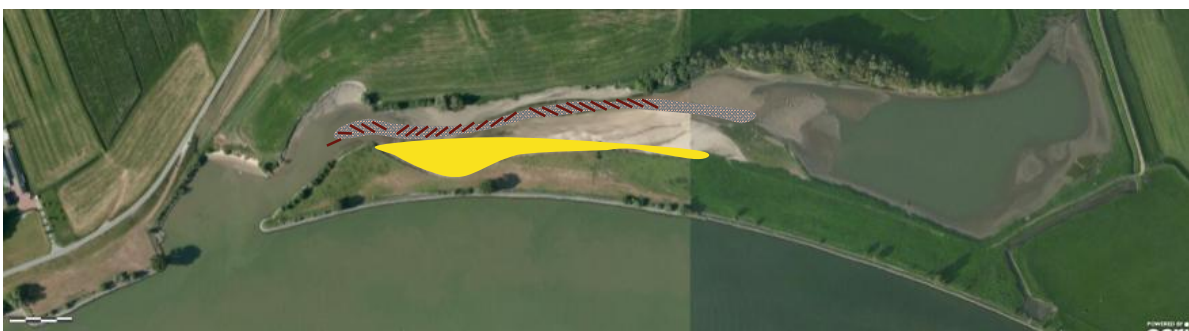
Figuur 12 Optie v, correctie (hoogwater)stroming met lage schermen in de diepe delen.
