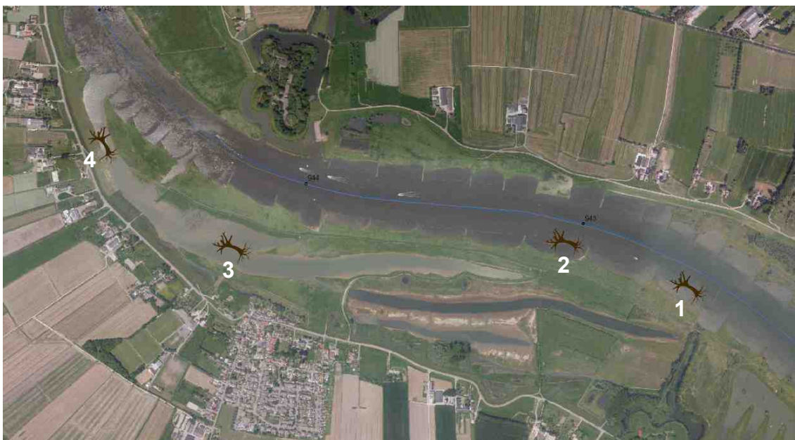
Figuur 3.4: Overzicht boomlocaties Everdingen. (Bron ondergrond: © Eurosense BV, DKLN2011). Locatie 1: 1 boom in open kribvak, locatie 2: 2 bomen achter vooroever, locatie 3: 2 bomen in strang, locatie 4: 1 boom in strang nabij de monding. (NB: bomen zijn niet op schaal!)
