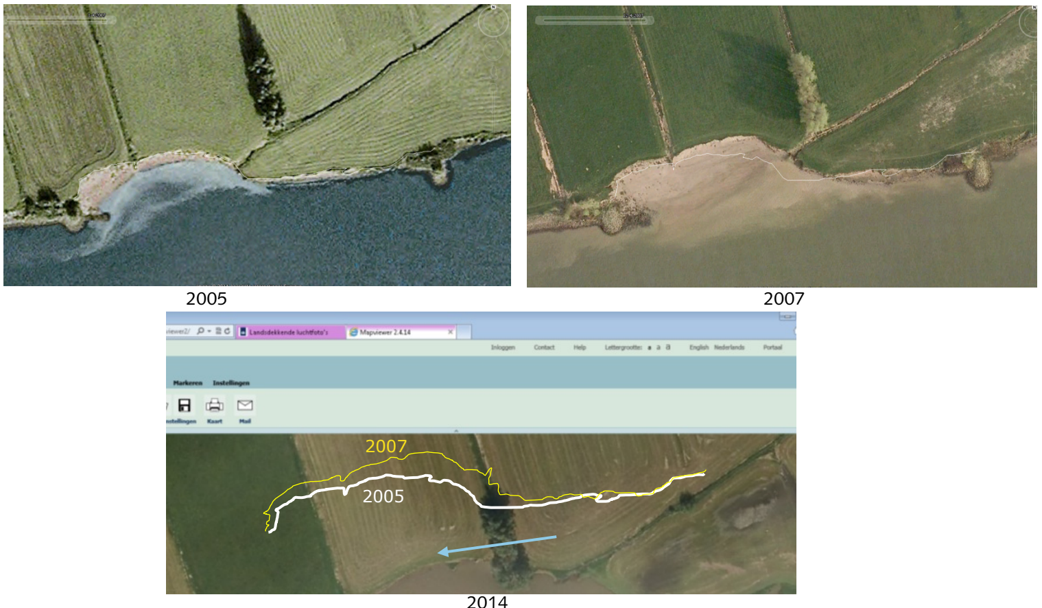
Figuur 3 Ontwikkelingen in oeverlijn op locatie 2, (rechteroever, km 967.5). Afstand tussen kribben 167 m.
