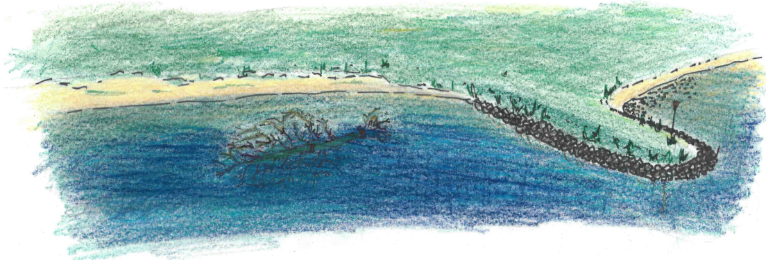
Figuur 1: Principeschets dood hout achter de vooroever nabij de krib. De boom ligt in de stroomschaduw van de krib.
