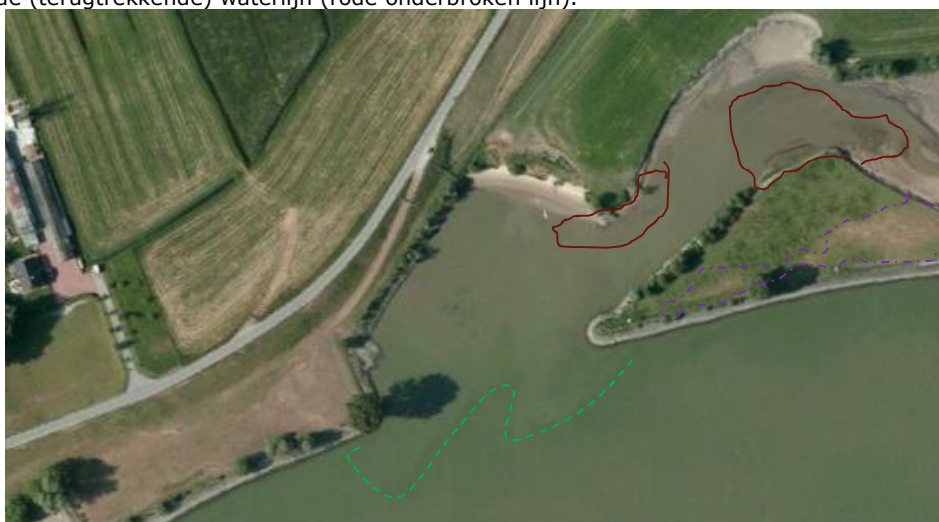
Opname 2011 van de benedenstroomse aansluiting. Terugkerend, slibrijk water vanuit de strang wisselt in een menglaag uit met het minder slibrijke rivierwater (groene stippellijn). Donkere delen ter hoogte van stabielere oevers (bruine getrokken lijnen) kan duiden op aanwezigheid van lokale, minder erodeerbare kleiachtige ondergrond.
