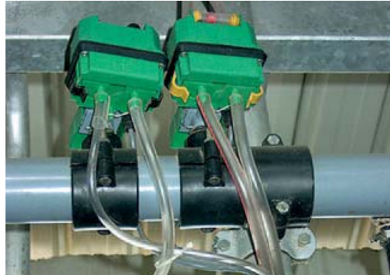
Aan de elektronische pulsator van SCR (rechts) is niets bijzonders te zien. Deze wordt aangestuurd door een externe controller. Links het ventiel voor de afname.
