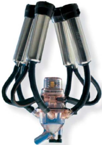
Bij het NuPulse-melkstel zit de pulsator in het koepelvormig kunststof kapje op de melkklaauw. De lengte van de melkkolom bepaalt het aantal cycli per minuut.
