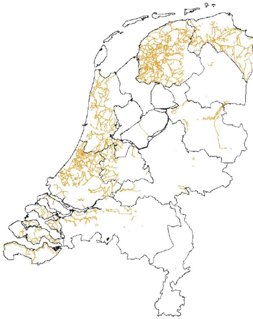
Figure 26: (en jaune) système de protections secondaires réglementé par les provinces, frontières des provinces (lignes noires) <sup>35</sup>
