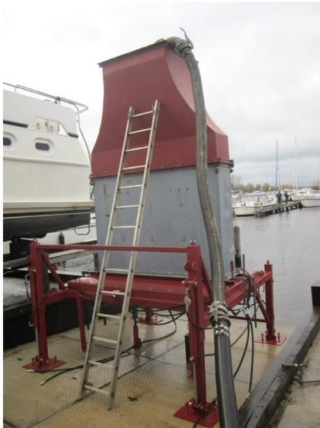
Picture 27. Filling till 3 m water column
