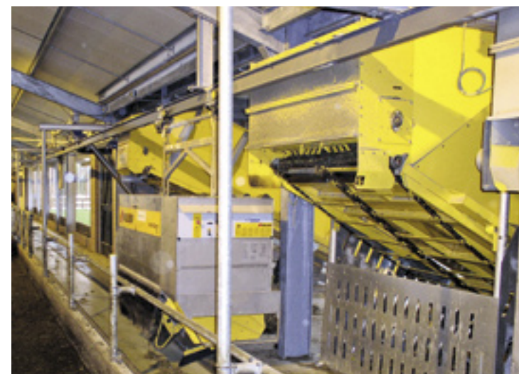
De ruimte onder de vuleenheden is veilig afgeschermd. Deze vuleenheden zijn niet uitgerust met een dubbele bodemplaat en een automatische afsluiter. Vuleenheden worden vanaf januari 2009 standaard geleverd met een dubbele bodemplaat.
