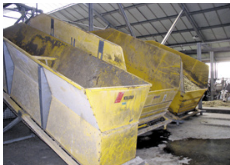
Eén vuleenheid van 7 m 3 en twee vuleenheden van 16 m 3 . De meeste gebruikte, brede vuleenheid van 16 m 3 kan gemakkelijk, snel en zonder morsverliezen worden geladen.
