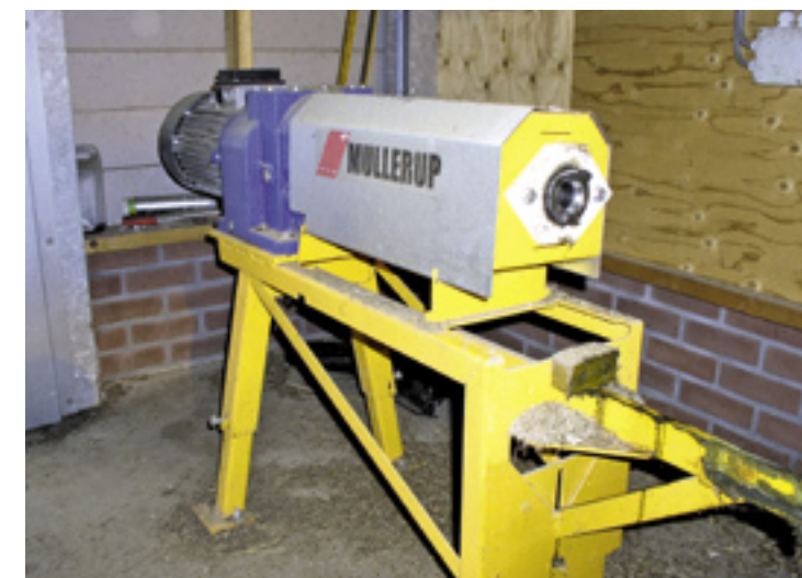
De MixFeeder koppelt zichzelf zonder moeite aan de krachtige 9,2 kW mixmotor. De mengtijd is per groep in te stellen.
